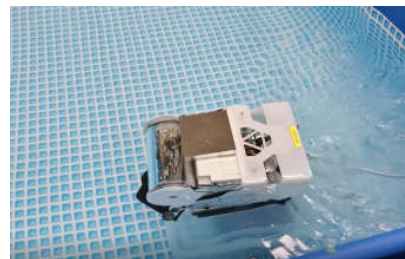
プールでの送電実験
